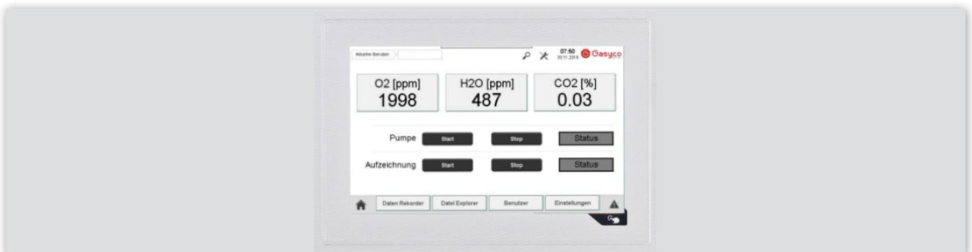
Der **interne Datenlogger** zeichnet jede Messung auf und speichert die Werte mit Zeit- und Datumstempel sowie benutzerdefiniertem Namen ab. Die Aufzeichnungen können dann über FTP oder USB auf den Computer übertragen werden. Außerdem kann die Steuerung, dank GSM-Modul, auch über eine VNC Verbindung von PC oder Smartphone betrachtet und bedient werden.
